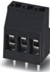
Morsetto per circuiti stampati, corrente nominale: 24 A, tensione di dimensionamento (III/2): 400 V, sezione nominale: 2,5 mm<sup>2</sup>, passo: 5,08 mm, numero poli: 2, collegamento: Connessione a vite con gabbia, montaggio: Saldatura ad onde, direzione di collegamento conduttore/scheda: 0 °, colore: nero, Layout Pin: Pinning lineare, Lunghezza pin [P]: 5 mm. Connessioni ponticellate internamente
