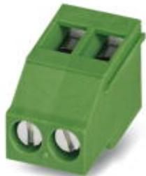
Morsetto per circuiti stampati, corrente nominale: 24 A, tensione di dimensionamento (III/2): 400 V, sezione nominale: 2,5 mm<sup>2</sup>, passo: 5 mm, numero poli: 10, collegamento: Connessione a vite con gabbia, montaggio: Saldatura ad onde, direzione di collegamento conduttore/scheda: 90 °, colore: verde, Layout Pin: Pinning lineare, Lunghezza pin [P]: 4,1 mm. L'articolo può essere allineato con diversi numeri di poli!
