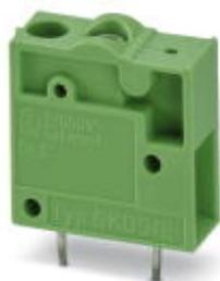
Morsetto per circuiti stampati, corrente nominale: 24 A, tensione di dimensionamento (III/2): 630 V, sezione nominale: 2,5 mm<sup>2</sup>, passo: 7,5 mm, numero poli: 1, collegamento: Connessione a vite con gabbia, montaggio: Saldatura ad onde, direzione di collegamento conduttore/scheda: 0 °, colore: nero, Layout Pin: Piedinatura doppia lineare, Lunghezza pin [P]: 5 mm
