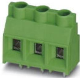
Morsetto per circuiti stampati, corrente nominale: 32 A, tensione di dimensionamento (III/2): 1000 V, sezione nominale: 4 mm<sup>2</sup>, passo: 9,52 mm, numero poli: 3, collegamento: Connessione a vite con gabbia, montaggio: Saldatura ad onde, direzione di collegamento conduttore/scheda: 0 °, colore: grigio chiaro, Layout Pin: Pinning lineare, Lunghezza pin [P]: 5 mm. L'articolo può essere allineato con diversi numeri di poli!
