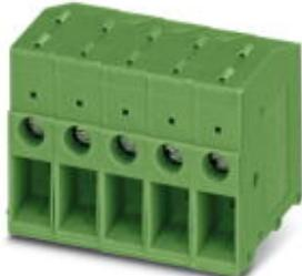
Morsetto per circuiti stampati, corrente nominale: 32 A, tensione di dimensionamento (III/2): 630 V, sezione nominale: 4 mm<sup>2</sup>, passo: 7,62 mm, numero poli: 2, collegamento: Connessione a vite frontale, montaggio: Saldatura ad onde, direzione di collegamento conduttore/scheda: 0 °, colore: verde, Layout Pin: Piedinatura doppia lineare, Lunghezza pin [P]: 5 mm
