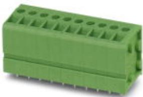
Morsetto per circuiti stampati, corrente nominale: 24 A, tensione di dimensionamento (III/2): 400 V, sezione nominale: 2,5 mm<sup>2</sup>, passo: 5 mm, numero poli: 2, collegamento: Connessione a vite frontale, montaggio: Saldatura ad onde, direzione di collegamento conduttore/scheda: 90 °, colore: verde, Layout Pin: Piedinatura doppia lineare, Lunghezza pin [P]: 3,5 mm
