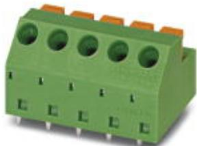
Morsetto per circuiti stampati, corrente nominale: 12 A, tensione di dimensionamento (III/2): 320 V, sezione nominale: 1 mm<sup>2</sup>, passo: 5,08 mm, numero poli: 5, collegamento: Connessione a molla Push-in, montaggio: Saldatura ad onde, direzione di collegamento conduttore/scheda: 45 °, colore: grigio, Layout Pin: Piedinatura doppia lineare, Lunghezza pin [P]: 3,3 mm
