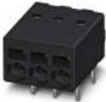
Morsetto per circuiti stampati, corrente nominale: 6 A, tensione di dimensionamento (III/2): 160 V, sezione nominale: 0,5 mm<sup>2</sup>, passo: 2,5 mm, numero poli: 8, collegamento: Connessione a molla Push-in, montaggio: Saldatura THR, direzione di collegamento conduttore/scheda: 0 °, colore: nero, Layout Pin: Piedinatura doppia lineare, Lunghezza pin [P]: 2,1 mm
