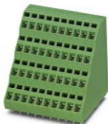
Morsetto per circuiti stampati, corrente nominale: 12 A, tensione di dimensionamento (III/2): 400 V, sezione nominale: 1,5 mm<sup>2</sup>, passo: 5,08 mm, numero poli: 4, collegamento: Connessione a molla, montaggio: Saldatura ad onde, direzione di collegamento conduttore/scheda: 45 °, colore: verde, Layout Pin: Pinning lineare, Lunghezza pin [P]: 3,4 mm
