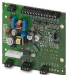
Il controllo di carica EV-CC-AC1-M3-CC-SER-PCB come circuito stampato è progettato per la ricarica di veicoli elettrici su reti trifase di corrente alternata secondo IEC 61851-1, modalità 3 e ottimizzato per le stazioni di ricarica dei veicoli con connettore fisso. Tutte le funzioni di carica e le numerose impostazioni di configurazione sono già integrate.
