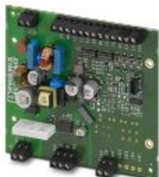
Il controllo di carica EV-CC-AC1-M3-CC-SER-PCB come circuito stampato è progettato per la ricarica di veicoli elettrici su reti trifase di corrente alternata secondo IEC 61851-1, modalità 3 e ottimizzato per le stazioni di ricarica dei veicoli con connettore fisso. Tutte le funzioni di carica e le numerose impostazioni di configurazione sono già integrate.
