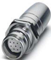
Passaggio parete posteriore, con filettatura Pg16, UC, diritto, schermati: sì, Bloccaggio a vite, M23, N. poli: 17, tipo contatti: femmina, Attacco a crimpare, O-ring assiale, Fissaggio centrale, diametro cavi: 6,5 mm ... 14,5 mm
