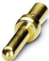
Contatto a crimpare, tornito, diametro contatti: 1 mm, intervallo di crimpatura: 0,08 mm<sup>2</sup> ... 0,22 mm<sup>2</sup>
