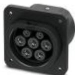
Presa di ricarica dell'infrastruttura, Collegamento a vite del coperchio di protezione sul lato posteriore, Per la ricarica con corrente alternata (AC) di veicoli elettrici, GB/T, GB/T 20234.2-2015, 32 A / 440 V (AC), Fili singoli, lunghezza: 0,7 m, Montaggio sulla parete anteriore e posteriore, Standard, **IMPORTANTE!** Questa variante dell'articolo non prevede l'attuatore di bloccaggio.
