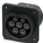
Presca di ricarica dell'infrastruttura. Collegamento a vite del coperchio di protezione sul lato posteriore. Per la ricarica con corrente alternata (AC) di veicoli elettrici, GB/T, GB/T 20234.2-2015, 32 A / 250 V (AC), Fili singoli, lunghezza: 0,7 m, Montaggio sulla parete anteriore e posteriore, Standard, **IMPORTANTE!** Questa variante dell'articolo non prevede l'attuatore di bloccaggio.
