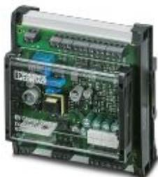
Il controllo dei carichi EV-CC-AC1-M3-CBC-SER-HS con custodia per montaggio su guida è progettato per caricare i veicoli elettrici su reti trifase a corrente alternata secondo IEC 61851-1 modalità 3. Tutte le funzioni di carico, le numerose impostazioni di configurazione e il controllo bloccaggio sono già integrati.
