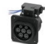
Presca di ricarica dell'infrastruttura, Collegamento a vite del coperchio di protezione sul lato posteriore, Per la ricarica con corrente alternata (AC) di veicoli elettrici, Compatibile con connettori di ricarica lato infrastruttura, Tipo 2, IEC 62196-2, 32 A / 480 V (AC), Fili singoli, lunghezza: 0,7 m, Attuatore di bloccaggio: 12 V, 4-poli, Montaggio sulla parete posteriore, Generazione 1
