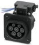
Presa di ricarica dell'infrastruttura, Collegamento a vite del coperchio di protezione sul lato posteriore, Per la ricarica con corrente alternata (AC) di veicoli elettrici, Compatibile con connettori di ricarica lato infrastruttura, Tipo 2, IEC 62196-2, 32 A / 480 V (AC), Fili singoli, lunghezza: 0,7 m, Attuatore di bloccaggio: 12 V, 4-poli, Montaggio sulla parete posteriore, Generazione 1
