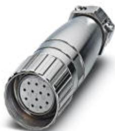
Connettore per cavi, con filettatura Pg13,5, RC, diritto, schermati: sì, Bloccaggio a vite, M23, diametro cavi: 3 mm ... 10,5 mm
