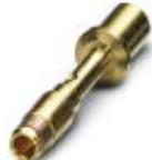
Contatto a crimpare, tornito, Contatto singolo, diametro contatti: 2 mm, intervallo di crimpatura: 0,25 mm<sup>2</sup> ... 1 mm<sup>2</sup>
