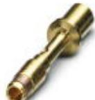
Contatto a crimpare, tornito, Contatto singolo, diametro contatti: 2 mm, intervallo di crimpatura: 0,75 mm<sup>2</sup> ... 1,5 mm<sup>2</sup>
