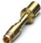
Contatto a crimpare, tornito, Contatto singolo, diametro contatti: 2 mm, intervallo di crimpatura: 4 mm<sup>2</sup> ... 4 mm<sup>2</sup>
