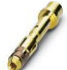
Contatto a crimpare, tornito, Contatto singolo, diametro contatti: 1 mm, intervallo di crimpatura: 0,06 mm<sup>2</sup> ... 0,25 mm<sup>2</sup>
