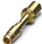
Contatto a crimpare, tornito, Contatto singolo, diametro contatti: 2 mm, intervallo di crimpatura: 1 mm<sup>2</sup> ... 2,5 mm<sup>2</sup>
