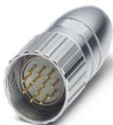
Connettore per cavo, RC, diritto, schermati: sì, Bloccaggio a vite, M23, N. poli: 16, tipo contatti: Maschio, Attacco a crimpare, diametro cavi: 3 mm ... 10,5 mm
