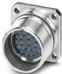
Connettore per apparecchi anteriore, diritto, Bloccaggio a vite, M27, numero poli: 26, tipo contatti: femmina, Attacco a saldare, Guarnizione piatta, 4x Ø 3,2
