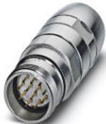
Connettore per giunti, UC, diritto, schermati: sì, Bloccaggio a vite, M23, N. poli: 17, tipo contatti: Maschio, Attacco a crimpare, diametro cavi: 9,5 mm ... 11,5 mm
