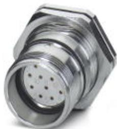
Connettore per apparecchi posteriore, RC, diritto, schermati: sì, Bloccaggio a vite, M23, O-ring assiale, Fissaggio centrale M25 x 1,5, Spessore della parete min.: 0,8 mm, Spessore della parete max.: 6,5 mm
