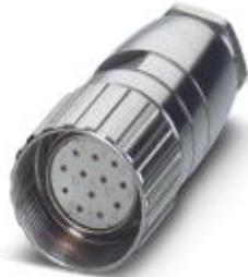
Connettore per cavo, RC, diritto, schermati: no, Bloccaggio a vite, M23, N. poli: 12, tipo contatti: femmina, Attacco a crimpere, diametro cavi: 6 mm ... 10 mm
