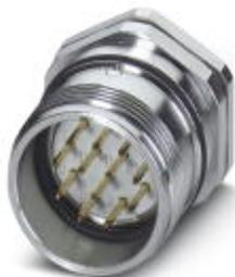
Connettori per apparecchi con filettatura a vite M20 x 1,5, RC, diritto, schermati: sì, Bloccaggio a vite, M23, N. poli: 12, tipo contatti: Maschio, Attacco a crimpare, O-ring assiale, Fissaggio centrale, Spessore della parete min.: 0,8 mm, Spessore della parete max.: 6,5 mm
