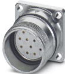
Connettore per apparecchi anteriore, RC, diritto, schermati: sì, Bloccaggio a vite, M23, N. poli: 6, tipo contatti: femmina, Attacco a saldare, O-ring assiale, 4x Ø2,7
