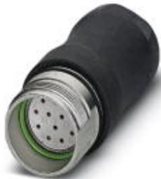
Connettore per giunti, RC, Plastica diritta, rivestita, schermati: sì, Bloccaggio a vite, M23, N. poli: 6, tipo contatti: femmina, Attacco a saldare, diametro cavi: 3 mm ... 10,5 mm
