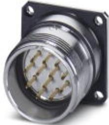
Connettore per apparecchi posteriore, RC, diritto, Bloccaggio a vite, M23, N. poli: 8+1, tipo contatti: Maschio, Attacco a crimpire, Guarnizione piatta, 4x Ø2,7, Spessore della parete min.: 2,7 mm, Spessore della parete max.: 3,5 mm
