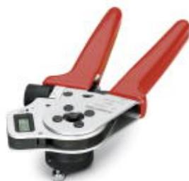
Pinza a crimpare per contatti a crimpare torniti Ø 1 mm / Ø 1,6 mm / Ø 2 mm / Ø 3,6 mm, sezione fili 0,08 mm<sup>2</sup> ... 6 mm<sup>2</sup>
