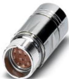
Connettore per giunti, diritto, Bloccaggio a vite, M23, numero poli: 17, tipo contatti: femmina, Attacco a crimpare, schermata: sì, diametro cavi: 5 mm ... 13,2 mm
