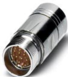
Connettore per giunti, diritto, Bloccaggio a vite, M23, numero poli: 17, tipo contatti: Maschio, Attacco a crimpare, schermata: sì, diametro cavi: 6 mm ... 10 mm
