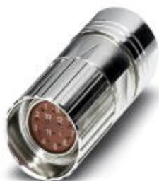
Connettore per cavi, diritto, Bloccaggio a vite, M23, numero poli: 12, tipo contatti: femmina, Attacco a crimpare, schermata: sì, diametro cavi: 6 mm ... 10 mm
