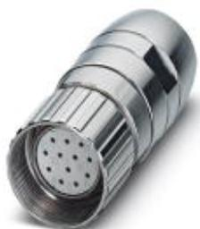
Connettore per cavo, UC, diritto, schermati: sì, Bloccaggio a vite, M23, N. poli: 17, tipo contatti: femmina, Attacco a crimpare, diametro cavi: 11,5 mm ... 13,5 mm
