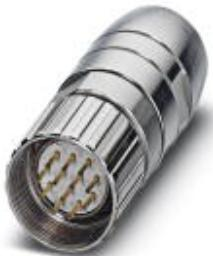
Connettore per cavo, UC, diritto, schermati: sì, Bloccaggio a vite, M23, N. poli: 17, tipo contatti: Maschio, Attacco a saldare, diametro cavi: 9,5 mm ... 11,5 mm
