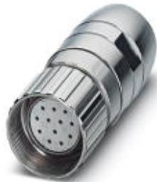
Connettore per cavo, UC, diritto, schermati: sì, Bloccaggio a vite, M23, N. poli: 12, tipo contatti: femmina, Attacco a saldare
