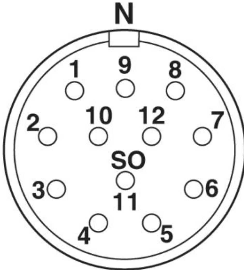
Connettore per apparecchi anteriore - TU-12S1N12WB00 - 1605967
