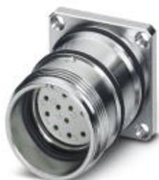
Connettore per apparecchi posteriore, RC, diritto, schermati: sì, Bloccaggio a vite, M23, N. poli: 6+3, tipo contatti: femmina, Connessione a saldare, Guarnizione piatta, 4xM3, Spessore della parete min.: 3 mm, Spessore della parete max.: 10,5 mm
