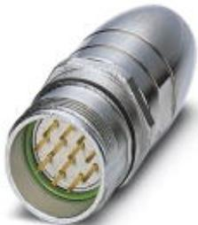
Connettore per giunti, RC, diritto, schermati: sì, Bloccaggio a vite, M23, N. poli: 6+3, tipo contatti: Maschio, Attacco a saldare, diametro cavi: 3 mm ... 10,5 mm
