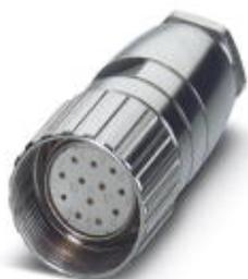
Connettore per cavi, con filettatura Pg13,5, RC, diritto, schermati: no, Bloccaggio a vite, M23, diametro cavi: 9 mm ... 13 mm
