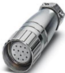
Connettore per cavi, con filettatura Pg13,5, RC, diritto, schermati: sì, Bloccaggio a vite, M23, N. poli: 16+3, tipo contatti: femmina, Attacco a saldare, diametro cavi: 9,5 mm ... 10,5 mm
