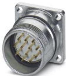
Connettore per apparecchi anteriore, RC, diritto, schermati: sì, Bloccaggio a vite, M23, N. poli: 16+3, tipo contatti: Maschio, Attacco a saldare, O-ring radiale, 4x Ø 3,2
