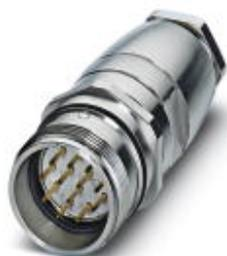
Connettore per giunti, con filettatura Pg13,5, RC, diritto, schermati: no, Bloccaggio a vite, M23, N. poli: 16+3, tipo contatti: Maschio, Attacco a saldare, diametro cavi: 10 mm ... 14 mm
