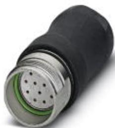
Connettore per giunti, RC, Plastica diritta, rivestita, schermati: sì, Bloccaggio a vite, M23, N. poli: 17, tipo contatti: femmina, Attacco a crimpare
