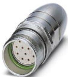
Connettore per giunti, RC, diritto, schermati: sì, Bloccaggio a vite, M23, N. poli: 17, tipo contatti: femmina, Attacco a saldare, diametro cavi: 7,5 mm ... 9,5 mm
