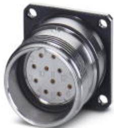
Connettore per apparecchi posteriore, RC, diritto, Bloccaggio a vite, M23, N. poli: 17, tipo contatti: femmina, Attacco a saldare, Guarnizione piatta, 4xM2,5
