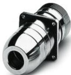
Passaparete posteriore, RC, diritto, schermati: sì, Bloccaggio a vite, M23, N. poli: 17, tipo contatti: Maschio, Attacco a crimpare, O-ring radiale, 4xM3, Spessore della parete max.: 2,5 mm
