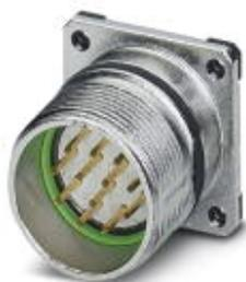
Connettore per apparecchi anteriore, RC, diritto, schermati: sì, Bloccaggio a vite, M23, N. poli: 17, tipo contatti: Maschio, Attacco a crimpare, Guarnizione piatta, 4x Ø2,7, misura flangia: 25 mm x 25 mm
