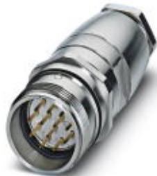
Connettore per giunti, con filettatura Pg11, RC, diritto, schermati: no, Bloccaggio a vite, M23, N. poli: 17, tipo contatti: Maschio, Attacco a saldare, diametro cavi: 8 mm ... 12 mm
