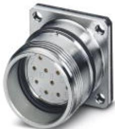
Connettore per apparecchi anteriore, RC, diritto, schermati: sì, Bloccaggio a vite, M23, N. poli: 16, tipo contatti: femmina, Attacco a crimpare, Guarnizione piatta, 4x Ø 3,2
