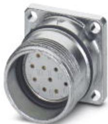
Connettore per apparecchi anteriore, RC, diritto, schermati: sì, Bloccaggio a vite, M23, N. poli: 16, tipo contatti: femmina, Attacco a saldare, O-ring radiale, 4x Ø 3,2
