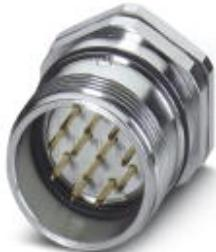
Connettori per apparecchi con filettatura a vite Pg 13,5, RC, diritto, schermati: sì, Bloccaggio a vite, M23, N. poli: 16, tipo contatti: Maschio, Attacco a crimpere, O-ring assiale, Fissaggio centrale, Spessore della parete min.: 1 mm, Spessore della parete max.: 4,5 mm
