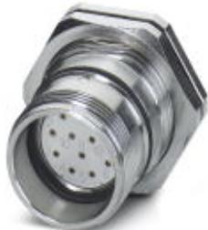
Connettore per apparecchi posteriore, RC, diritto, schermati: sì, Bloccaggio a vite, M23, N. poli: 12, tipo contatti: femmina, Attacco a saldare, O-ring assiale, Fissaggio centrale M25 x 1,5, Spessore della parete min.: 0,8 mm, Spessore della parete max.: 6,5 mm
